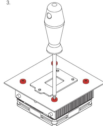
**Attention :** il est important de serrer normalement, et sans excès, les vis jusqu'à leur arrêt (max. torque 0,6 Nm).
