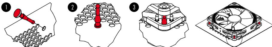
En cas de nécessité, il est aisé de détacher les silentbloks intégrés aux angles du NF-F12.
