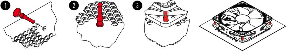
Si resultara necesario, puede quitar los paneles anti-vibración integrados del NF-A15 PWM fácilmente:
