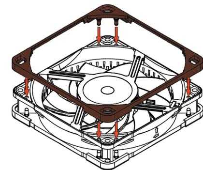
Le joint anti-vibrations NA-AVG1 peut être utilisé dans d'autres applications nécessitant un ajustement optimal avec le ventilateur.
